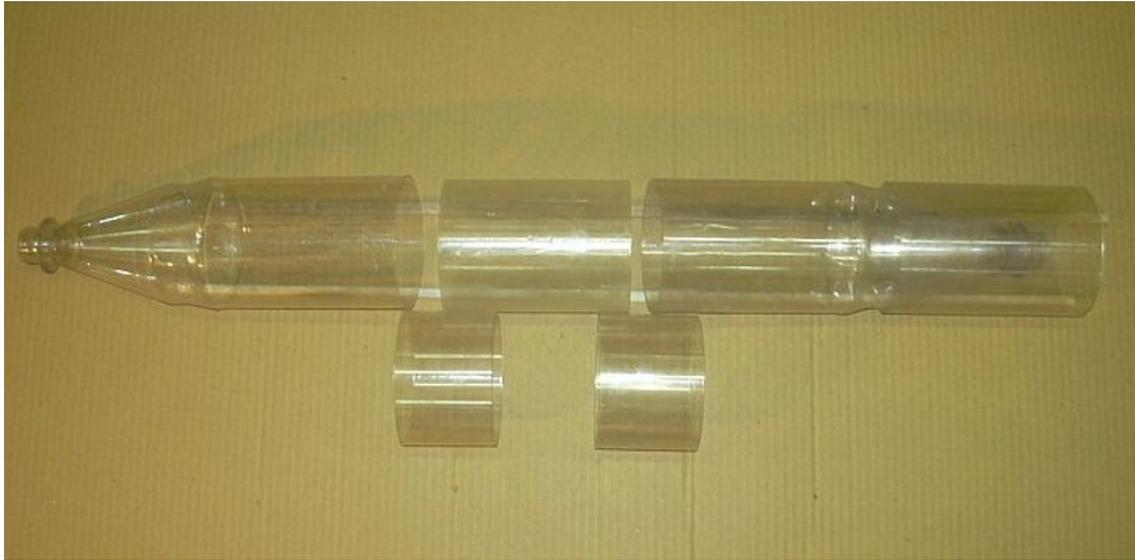
Jetzt müssen die beiden Muffen mit groben Schmirgelpapier (Körnung 80 oder 100) auf der Außenseite angeschliffen werden. Das Ober- und Unterteil sowie das Mittelstück ca. 4 cm tief auf der Innenseite anschleifen. Die Oberfläche sollte schön angeraut sein und keine glatten Stellen mehr zeigen.
