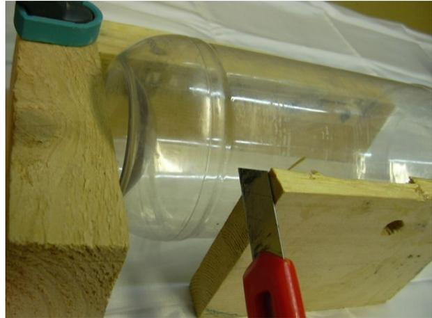
Im nächsten Arbeitsgang wird das Mittelstück des Druckkörpers und die beiden Muffen geschnitten. Die Technik des Schneidens ist die gleich wie oben bereits beschrieben.
