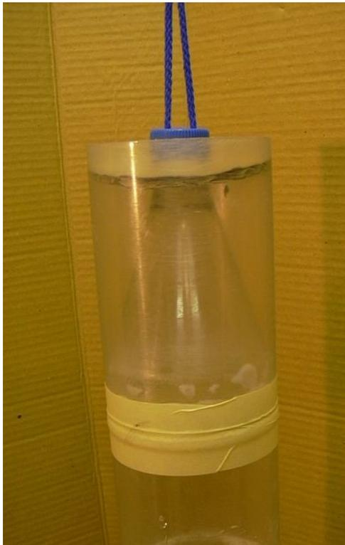
Die Stelle an dem Druckkörper an dem Kopfstück anliegt mit Schmirgelpapier aufrauen und entfetten. Das Kopfstück innen ebenfalls anschleifen und entfetten. Dann reichlich Kleber innen auf dem Rohrstück auftragen und auf den Druckkörper schieben, den Pappiring aufstecken, den Wasserraketenaufhänger aufschrauben und die Rakete aufhängen. Da der PU Kleber aufschäumt kann das Kopfstück verrutschen daher an der Nahtstelle einen Streifen Klebeband um die Verbindungsstelle legen.
