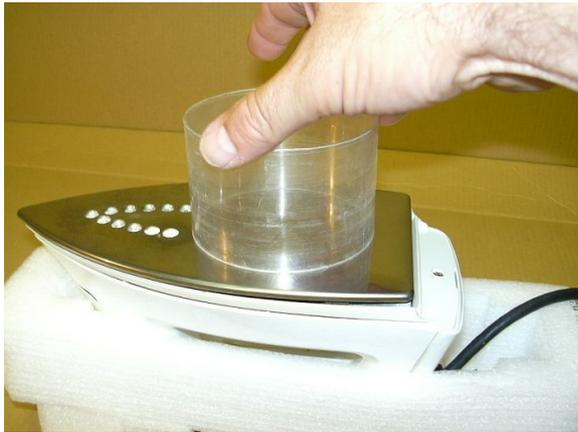
Das Bügeleisen auf eine Temperatur zwischen Baumwolle und Seide stellen und in die Halterung legen. Dann erst mal warten bis die Temperatur erreicht wurde. Die Muffen dann auf die Platte legen und langsam per Hand drehen. Dabei den Rand der Muffe beobachten wenn die Muffe anfängt zu schrumpfen noch ein wenig weiter drehen bis sie gleichmäßig den Durchmesser verringert hat.
