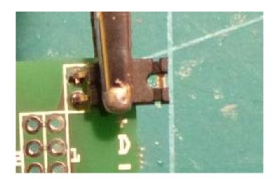
Wir beginnen mit dem Einlöten der 2-poligen gebogenen Stiftleiste. Um zu vermeiden, dass die Stifte schief eingelötet werden, setzen wir einen Jumper auf die Stifte.
