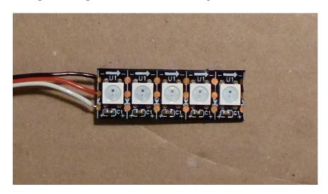
Wir löten das weiße bzw. gelbe Kabel an die Plus-Leitung, das schwarze bzw. braune an die Minus-Leitung, das rote an die Datenleitung, also den Lötpunkt in der Mitte. Das passt dann auch von der Position her zu den Anschlüssen am Neopixel-Controller. Mir ist bewusst, dass die Farben des Kabels nicht der üblichen Konvention entsprechen, aber so war es möglich, die kostengünstigen Servoverlängerungskabel zu verwenden.
