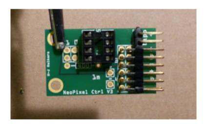
Jetzt kann die 8-polige IC-Fassung eingelötet werden. Dabei achten wir darauf, dass sie so eingesetzt wird, dass die Aussparung oben ist, also wie oben im Bild gezeigt da, wo die '5' vom Text "ATtiny85" zu sehen ist.
