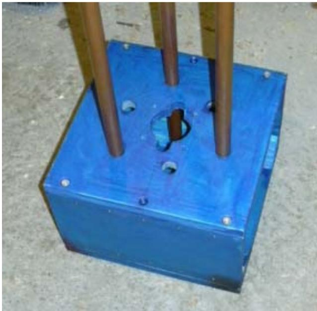
Nun kann man den Deckel auf dem fertigen Unterteil ausrichten und Löcher zur Befestigung anzeichnen, vorbohren und verschrauben. Jetzt kann man schon mal die Kupferrohre in die Kiste stecken und prüfen ob auch alles gerade ist. Wenn alles OK ist dann erst mal alle Teile anstreichen und gut trocknen lassen. Den Anstrich wiederholt man am besten noch einmal nach einem kurzen überschleifen damit auch alles wasserdicht wird.
