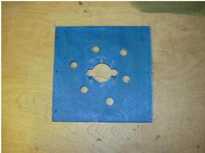
Jetzt bohrt mit einem 15mm Forstnerbohrer Löcher an den vorher angezeichneten Stellen d.h. bei den Punkten 1,2,3 bis 6.
